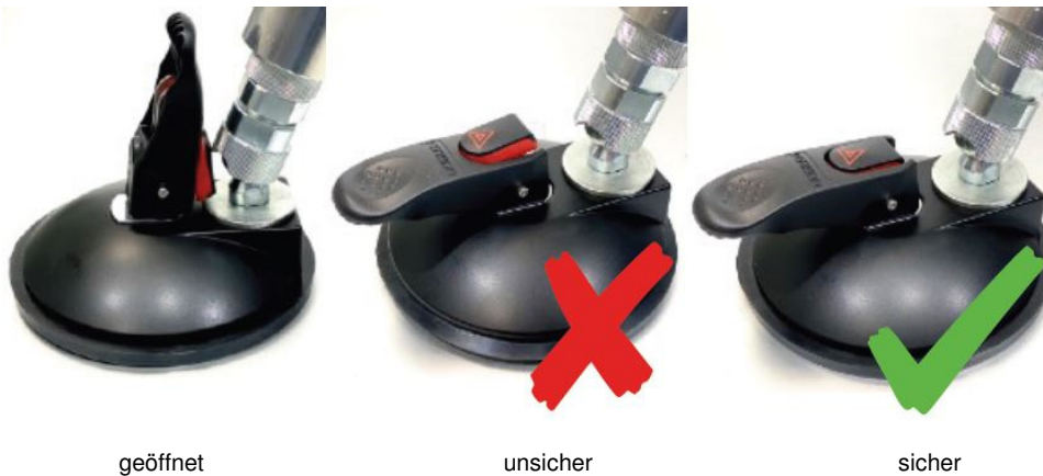
Saugfuß mit Vakuumanzeige Bild 16
